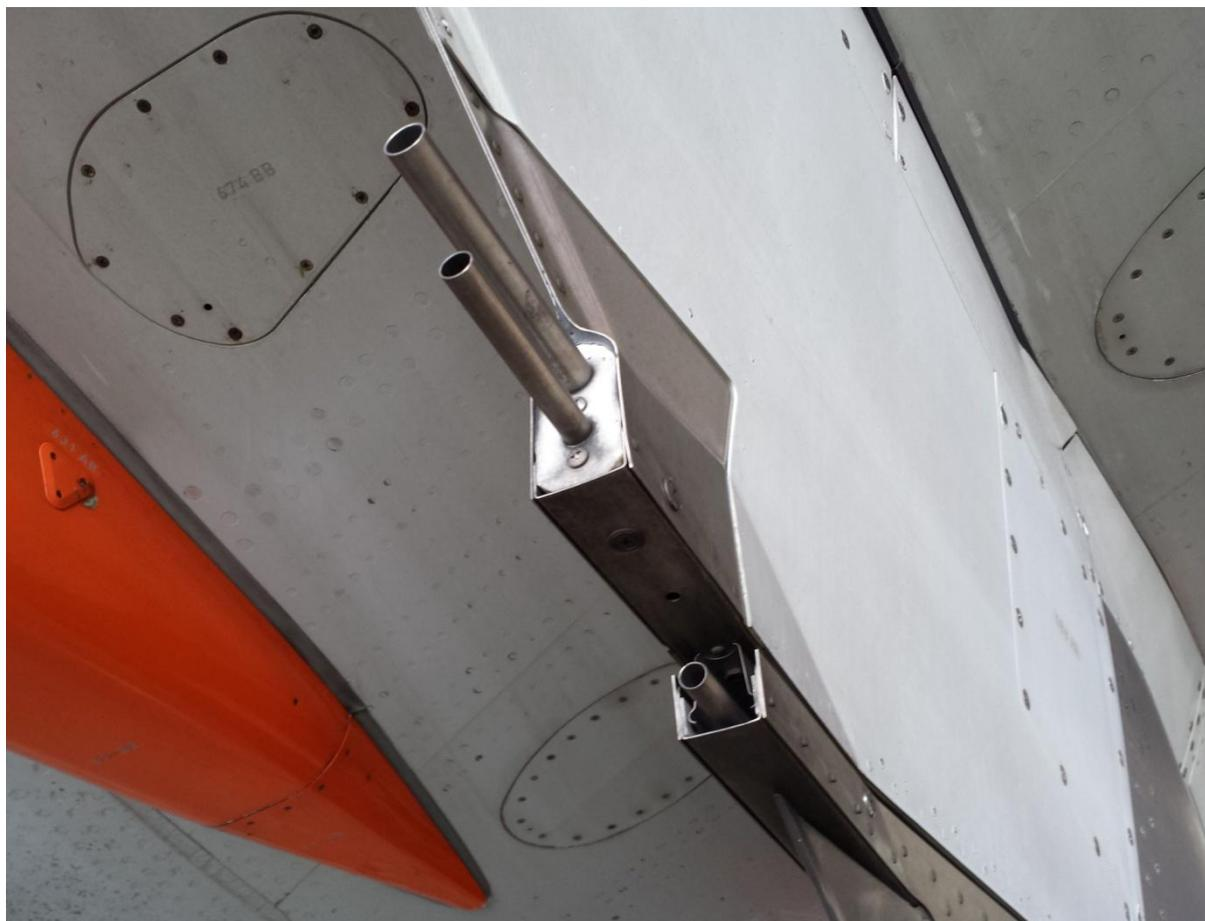
Questa è l'immagine più chiara dei tubi di scarico che ho finora. Chiaramente non sono originali dell'aereo, con saldature e rivettature visibili, il metallo di colore diverso e il design complessivo ha un aspetto molto artigianale, come se fosse una modifica rapida eseguita nel modo più economico possibile da qualcun altro rispetto al produttore dell'aereo.
