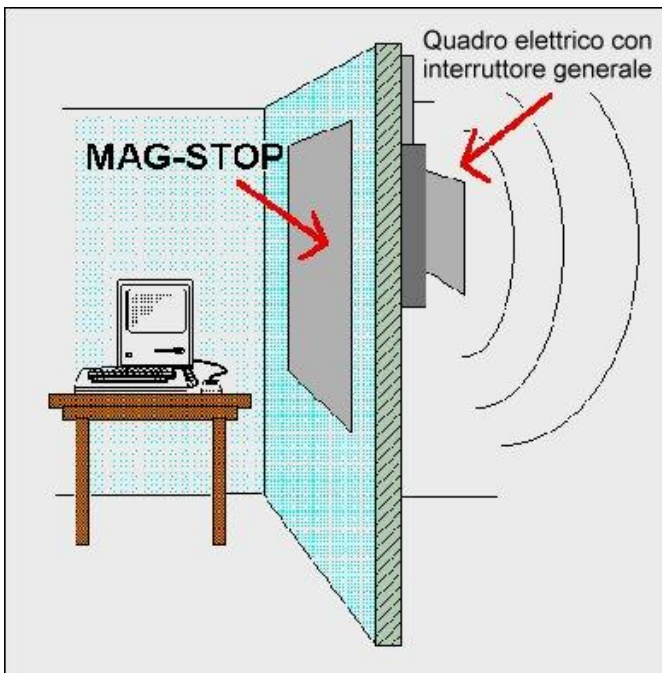
Schermatura dei campi magnetici a bassa frequenza con pannelli Mag-Stop.
