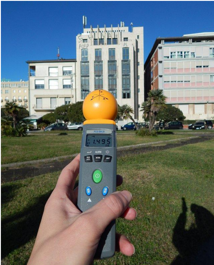
L'emissione di una stazione radio base della telefonia mobile (1,49 V/m).
