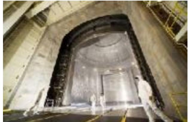
Sono necessarie molte ore per pompare fuori l'aria e arrivare a 10 alla meno 6 Torr. La struttura ha pareti di cemento da 1,8 a 2,5 metri, rinforzate con una barriera di contenimento incorporata in acciaio a tenuta stagna, in modo che la polvere di cemento e nemmeno l'aria, possano essere aspirate attraverso le pareti nella camera stessa e rovinare il vuoto che cercano di creare.
